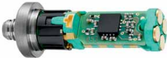
Drucksensor DS8 für ESP Bremsregelsysteme in MID-Technik Bildquelle: Robert Bosch GmbH
